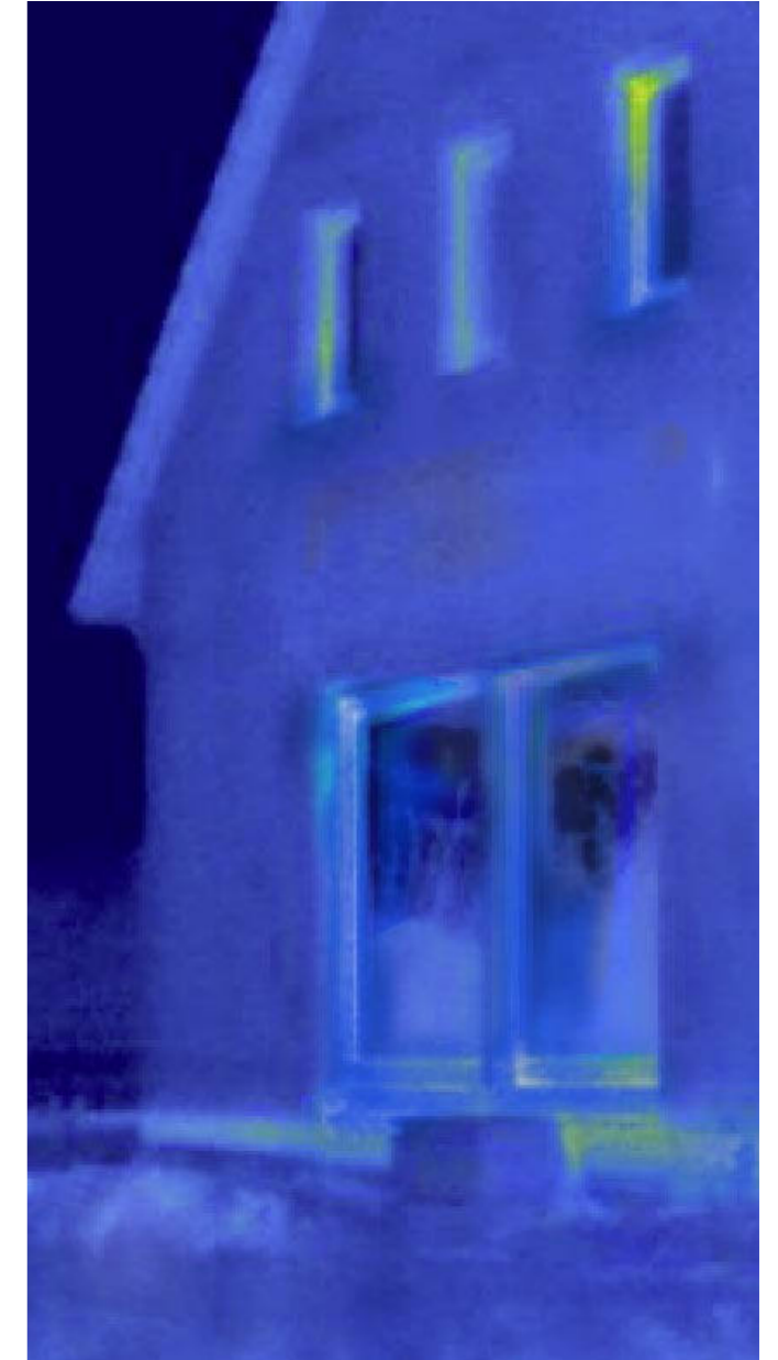
Nach der Renovierung: Der Einsatz der Hebeschiebetür GENE0 reduziert die Wärmeverluste erkennbar.
